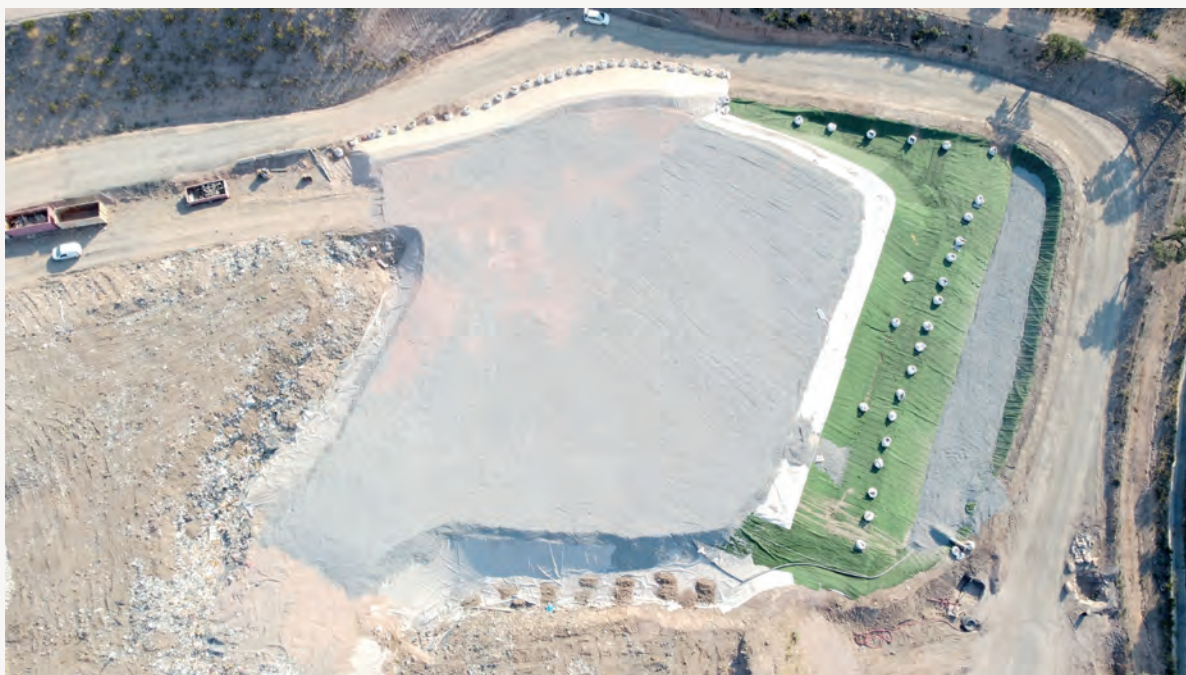
Aménagement du dernier casier de la rehausse, sur le dôme du site 3 (réception en août 2022)
