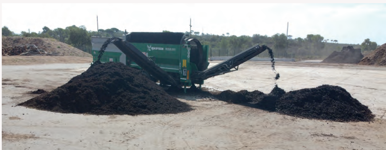
Criblage du compost
